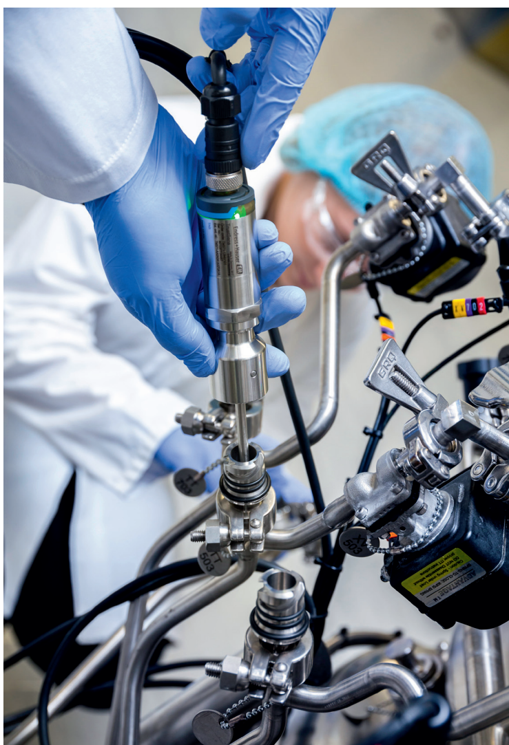
De sanitaire thermometer iTherm TrustSens heeft geautomatiseerde inline zelfkalibraties.
